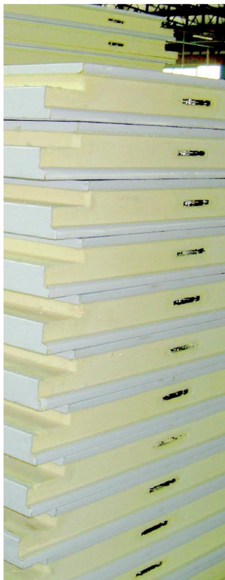
L'isolamento termico dei pannelli isolanti è ottenuto con schiuma poliuretanică espansa PUR (densità 41/43 Kg/m<sup>3</sup>) per iniezione sotto pressa oleodinamica.
